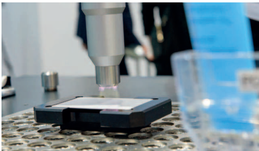
Plasmaaktivierung von Kunststoffoberflächen für verbesserte Haftungseigenschaften
