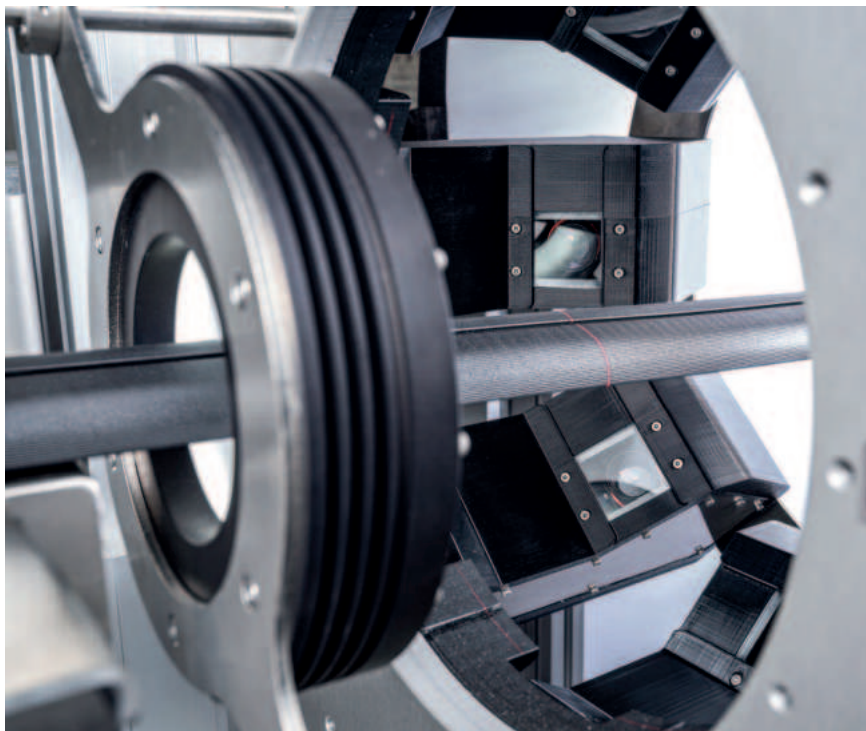
ProfilControl 7 RubberFlex ist mit bis zu 8 Multi-Area-Kameras frei konfigurierbar. Die flexible Kamerapositionierung erfasst kontinuierlich und lückenlos alle späteren Sichtbereiche. Keine Chance für Deformationen – präzise Maßhaltigkeit auf ganzer Linie
