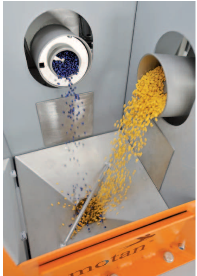
Fallmischprinzip in einem Synchrondosiergerät
